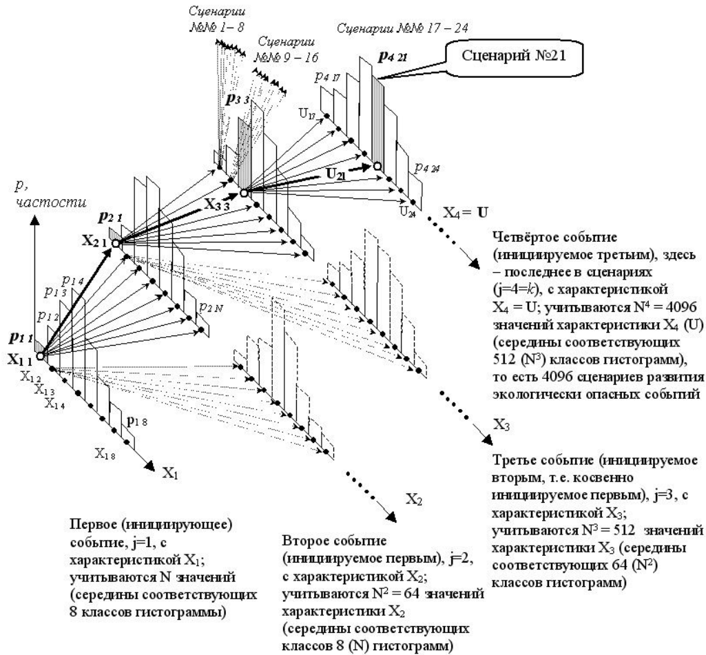
Рис. 1. Условный упрощённый пример схемы риск-анализа: количество событий в сценариях k=4 , количество классов в гистограммах значений X_1 - X_4 (количественно характеризующих степень проявления соответствующих событий №№ 1 – 4) N=8 , последнее, четвёртое событие – формирование ущерба U .
